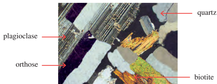
Figure 6.3 – Structure et composition minéralogique du granite.
